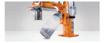
De plus, pendant le fonctionnement normal, les flacons de test empêchent la contamination à proximité de la machine de production.
