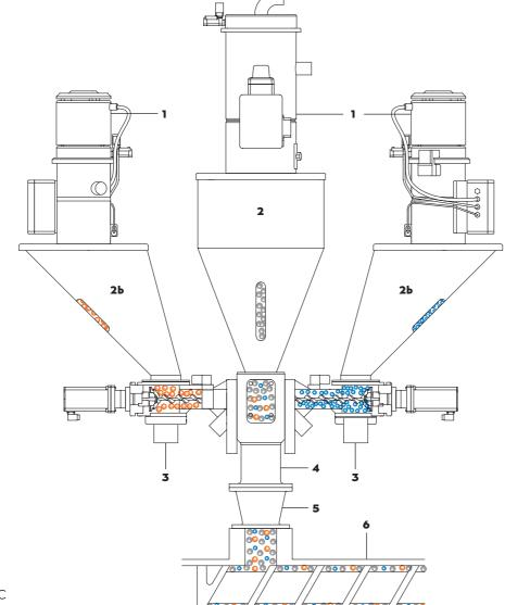
Les stations de dosage sont conçues pour des machines de traitement à production la plus constante possible.
