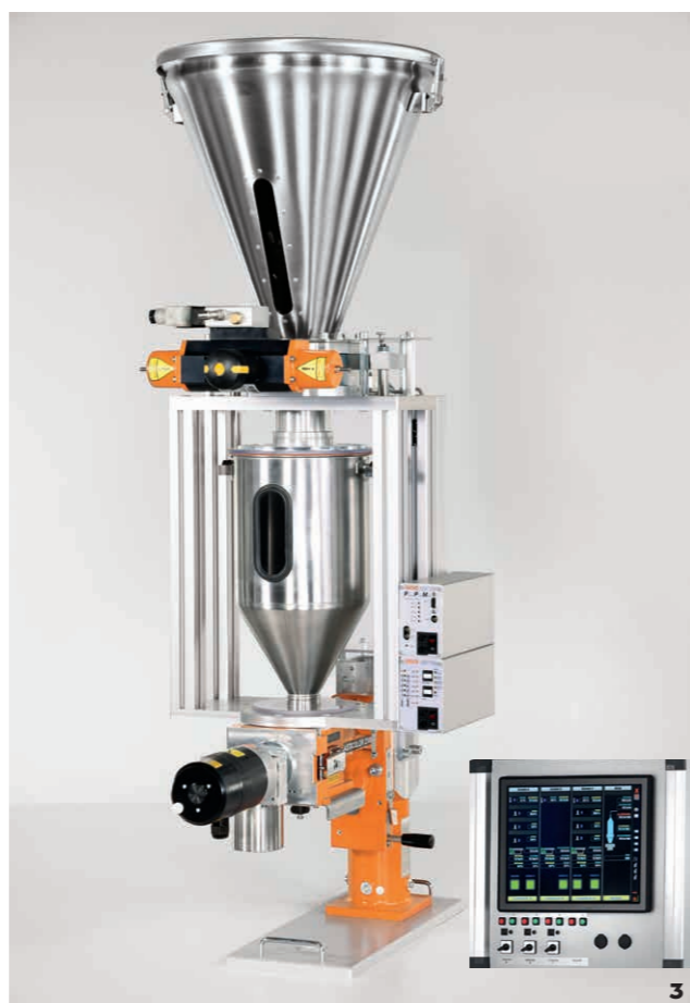
3 Appareil PLASTICOLOR avec trémie peseuse avec Module interface PPM, façade fonctionnelle PPM : Configurations de base (calibration, tarage, changement de vis, test de quantité etc.) PC ou Écran Raccordement Commande par bus à partir de l'API du client ou de la commande d'écran tactile PPM
