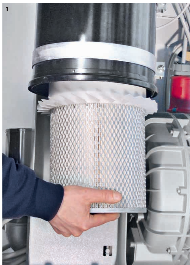
1 中央过滤器 PLASTICOLOR 吸入式运输机可配备一个能轻松够及的中央过滤器。
