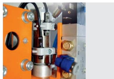
**Capteur de position obturateur de colonne centrale**
